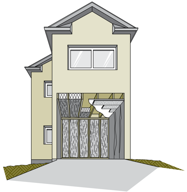
Figure 7-11 Étanchéisation et isolation entre la maison et un garage non chauffé
