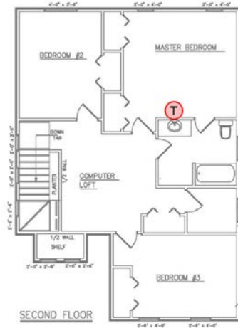
Figure 6-2 : Emplacement du thermostat dans la chambre principale à l'étage supérieur
