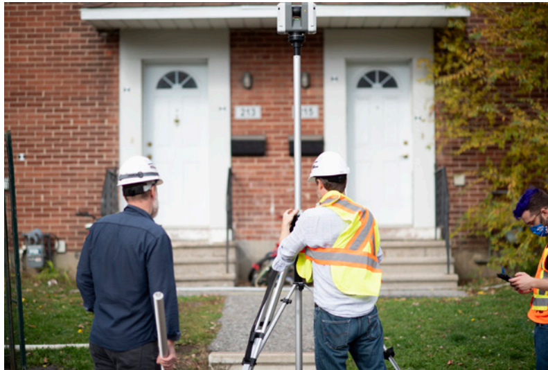
Figure 7-6 : Techniciens de terrain utilisant un scanner laser 3D (LiDAR) pour mesurer un bâtiment existant.
