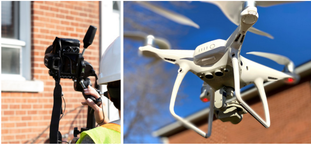
Figure 7-5 : Données photographiques capturées par reflex numérique et par drone pour le modèle de photogrammétrie.
