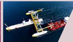
MEVM 2.15.1 Matériel de production d'électricité à partir de l'énergie cinétique de l'eau en mouvement ou marémotrice
