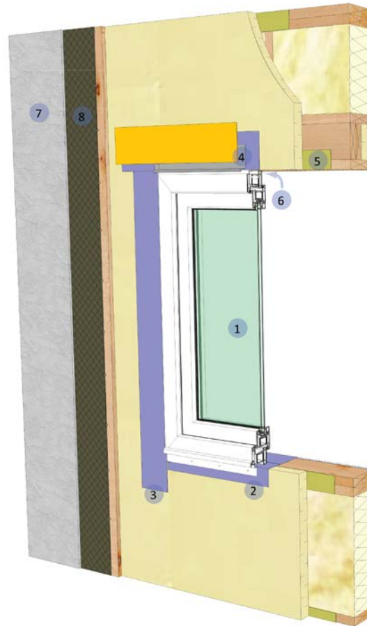
Figure13 : Fenêtres à bride de clouage installées par le constructeur et fixées au travers de l'isolant dans l'ossature. Référence photographique: Ressources naturel Canada
