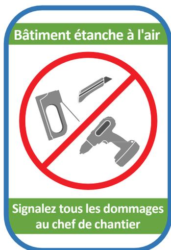
Figure 18 Exemple de panneau d'étanchéité à l'air à utiliser sur le chantier pour informer l'ensemble du personnel et des corps de métier
