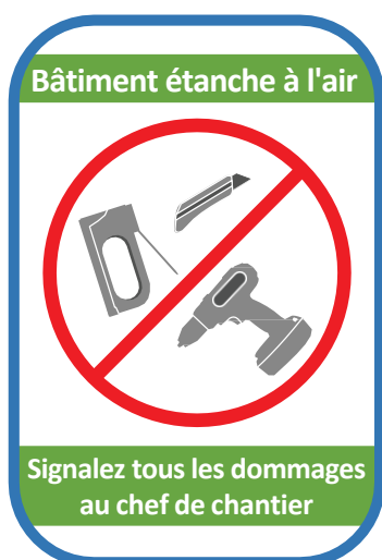
Figure 33 Exemple de panneau d'étanchéité à utiliser sur le chantier pour informer l'ensemble du personnel et des corps de métier.
