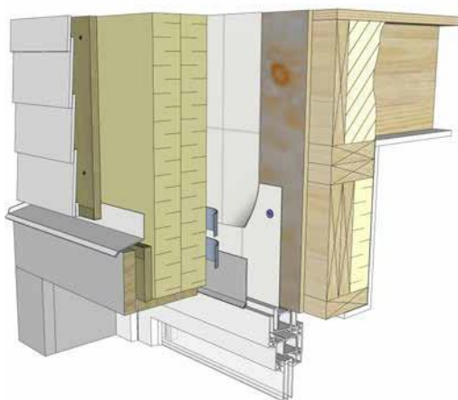
Figure 22 Solin de tête de fenêtre installé sur la face avant de l'isolation extérieure avec solin secondaire installé directement au-dessus de la fenêtre.
