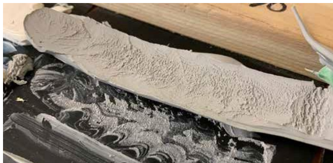
Figure 5 Exemple de rupture d'adhérence du cordon d'étanchéité.
