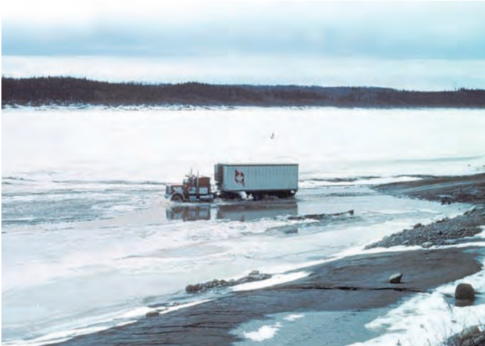
FIGURE 17 : Camion traversant une route de glace en dégel, au passage de Liard Ferry, près de Fort Simpson, sur la rivière Liard, dans les Territoires du Nord-Ouest. (Terry D. Prowse).
