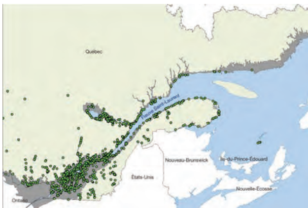
FIGURE 22 : Inventaire des demandes d'intervention en raison de glissements de terrain au Québec, entre 1972 et 2005. La zone en gris dénote les limites de l'invasion marine postglaciaire caractérisée par des dépôts argileux, (carte fournie par le Ministère des Transports du Québec, communication personnelle 2006).
