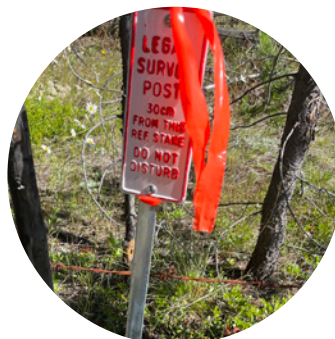
Exemple d'un poteau témoin en métal
