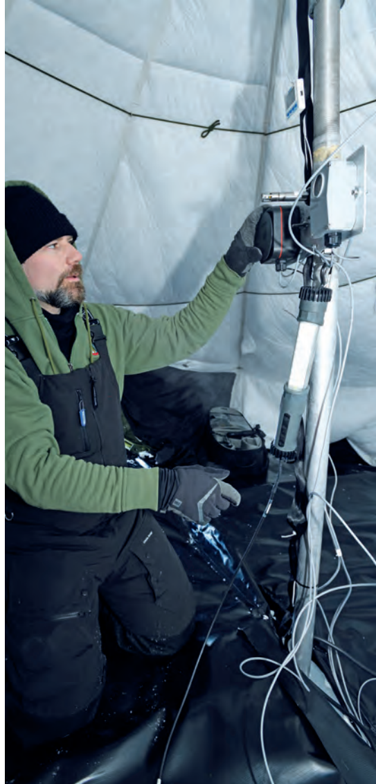
Installation de capteurs de température, de monoxyde de carbone et de dioxyde de carbone dans une tente expérimentale de 10 places près de Resolute, Nunavut
