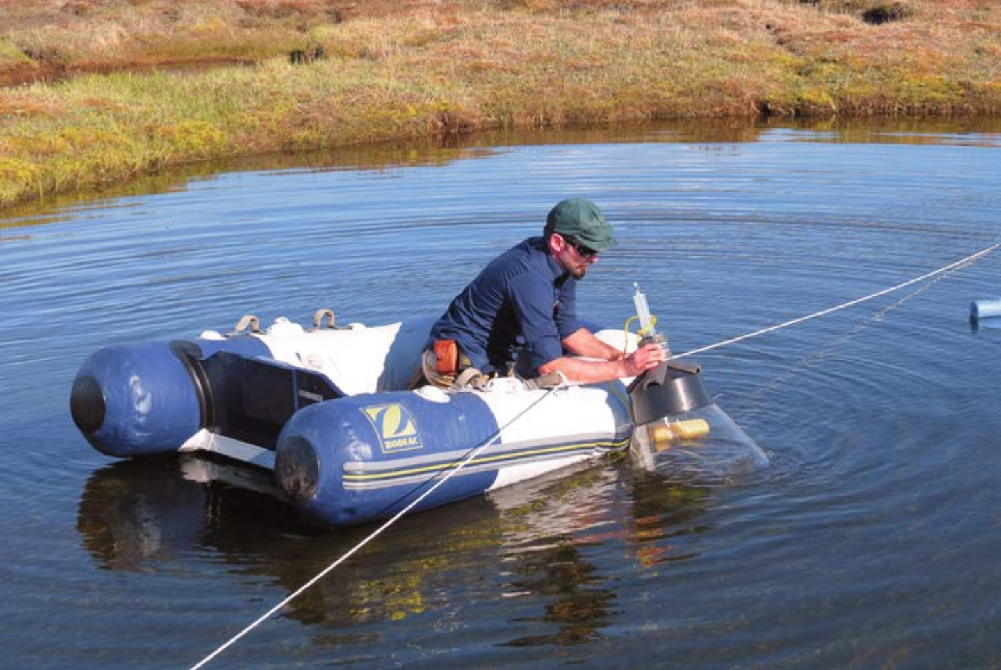
Installation d'un entonnoir inversé dans un étang polygonal de la vallée Qarlikturvik du parc Sirmilik, sur l'île Bylot, afin de mesurer le méthane rejeté par les sédiments de l'étang et sa contribution à l'effet effet de serre
