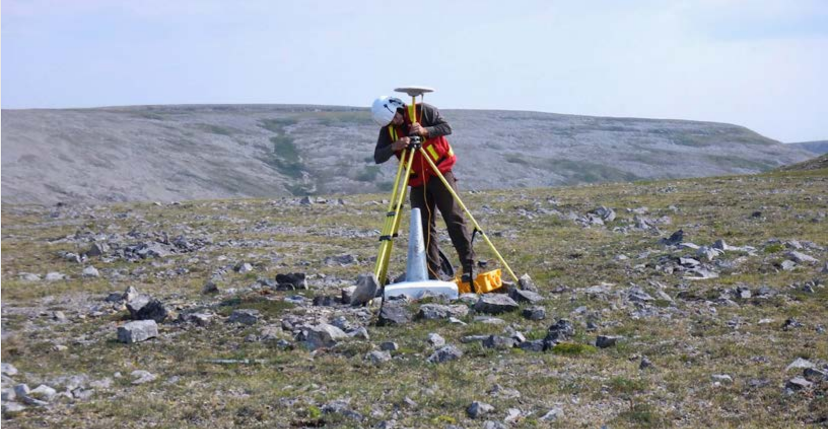
Mise en place d'un récepteur GPS sur une balise de délimitation qui marque la frontière entre le Yukon et l'Alaska, tout en effectuant un relevé le long du 141° méridien
