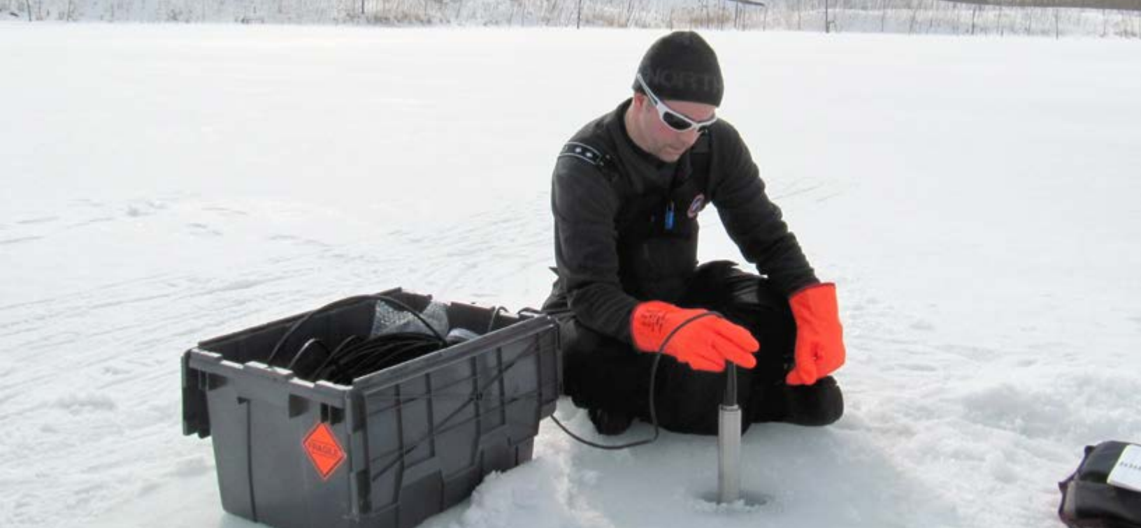
Surveillance des changements verticaux de la chimie de l'eau dans une fosse inondée à l'aide d'une sonde multiparamètre de qualité des eaux
