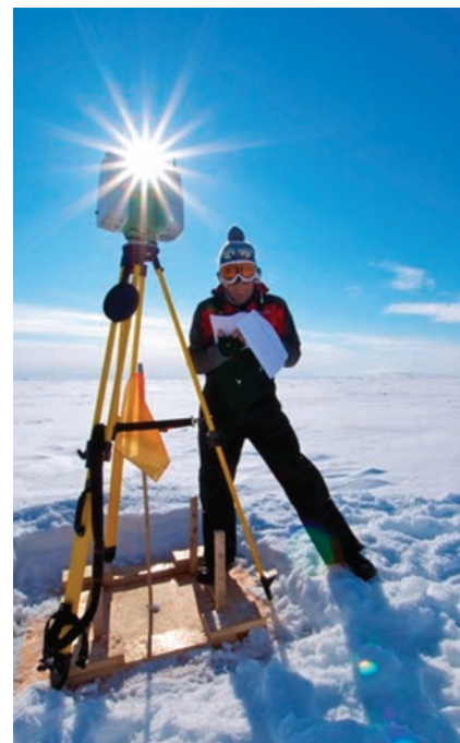
L'étudiant au doctorat, Jack Landy, installe un lidar de cartographie tridimensionnel utilisé pour observer l'évolution de la fonte de la surface de glace de neige et de mer.
