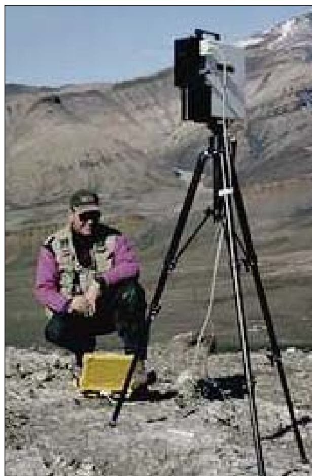
Figure 2. Spectromètre de terrain en fonction sur une cible dans le socle rocheux du Haut-Arctique. (Photo: Paul Budkewitsch)
