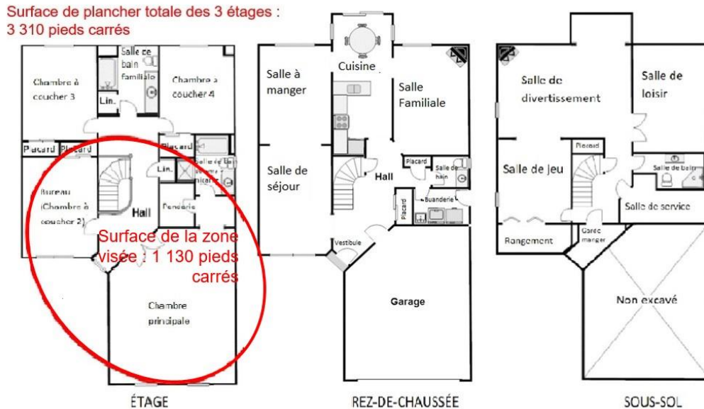
Figure 17: Plans d'étage d'une habitation à deux étages avec zone visée du deuxième étage encerclée
