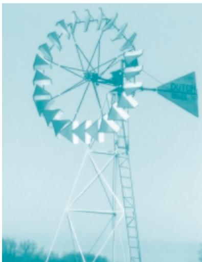
▲ Éolienne de pompage mécanique.
