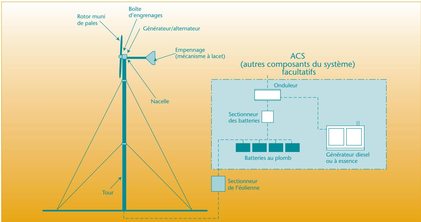
▲ Figure 6. Composants du système éolien.
