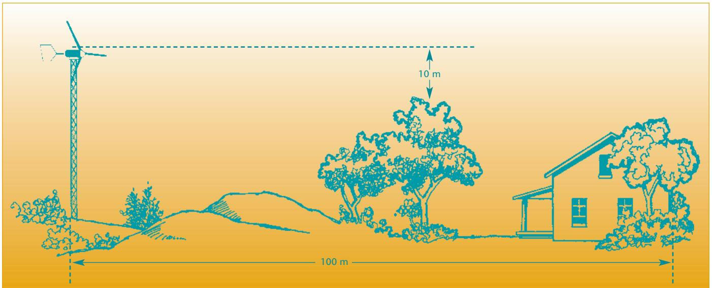
▲ Figure 11. Implantation d'un système d'énergie éolienne.
