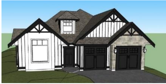
Figure 3 : La lucarne sud limite le potentiel solaire PV sur l'exposition sud – avec l'aimable autorisation de Sonbuilt Homes
