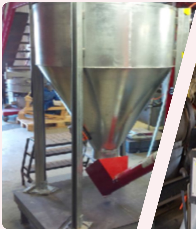
Trémie d'alimentation avec convoyeur à vis
