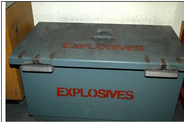
Figure 9 – exemple de poudrière de type-6
