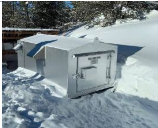
Figure 14 - exemple de poudrière de type-9
