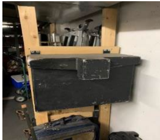
Figure 12 – exemple de poudrière de type-6
