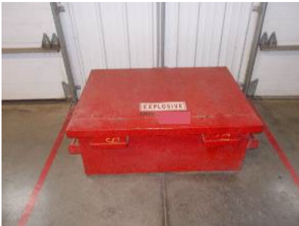
Figure 11 – exemple de poudrière de type-6
